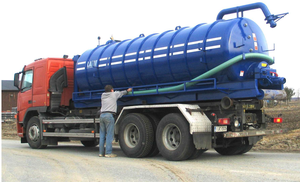
12000 litran säiliö koukkulavarungolla saksalaisen standardin mukaan. Alusta Meillerin valmistama. Täyttöputki myös yläkautta Pohjois-Suomen kylmiä olosuhteita varten.
