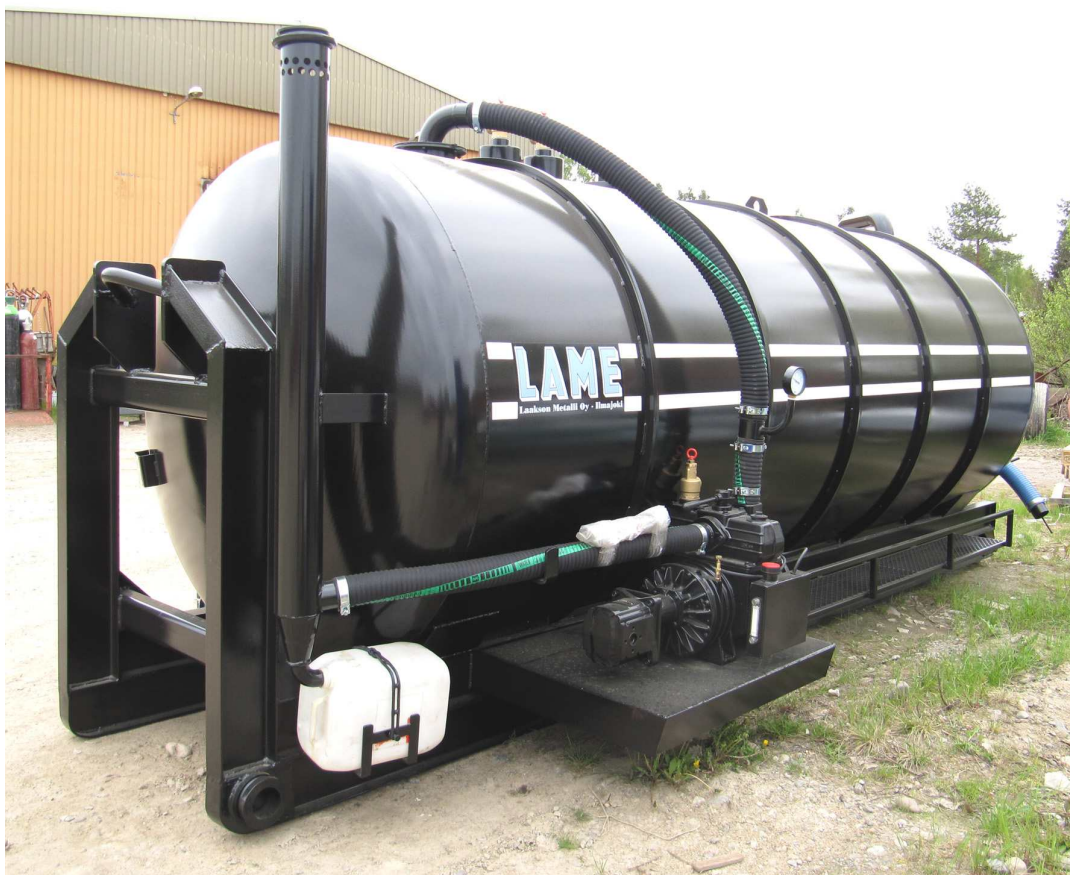
12500 litran lokasäiliö halkaisijalla 1800 mm. Tyhjiöpumppu 14000 l/min sekä äänenvaimennin/öljynkerääjä. Runko sopii sekä vaijeri- että koukulaitteelle.
