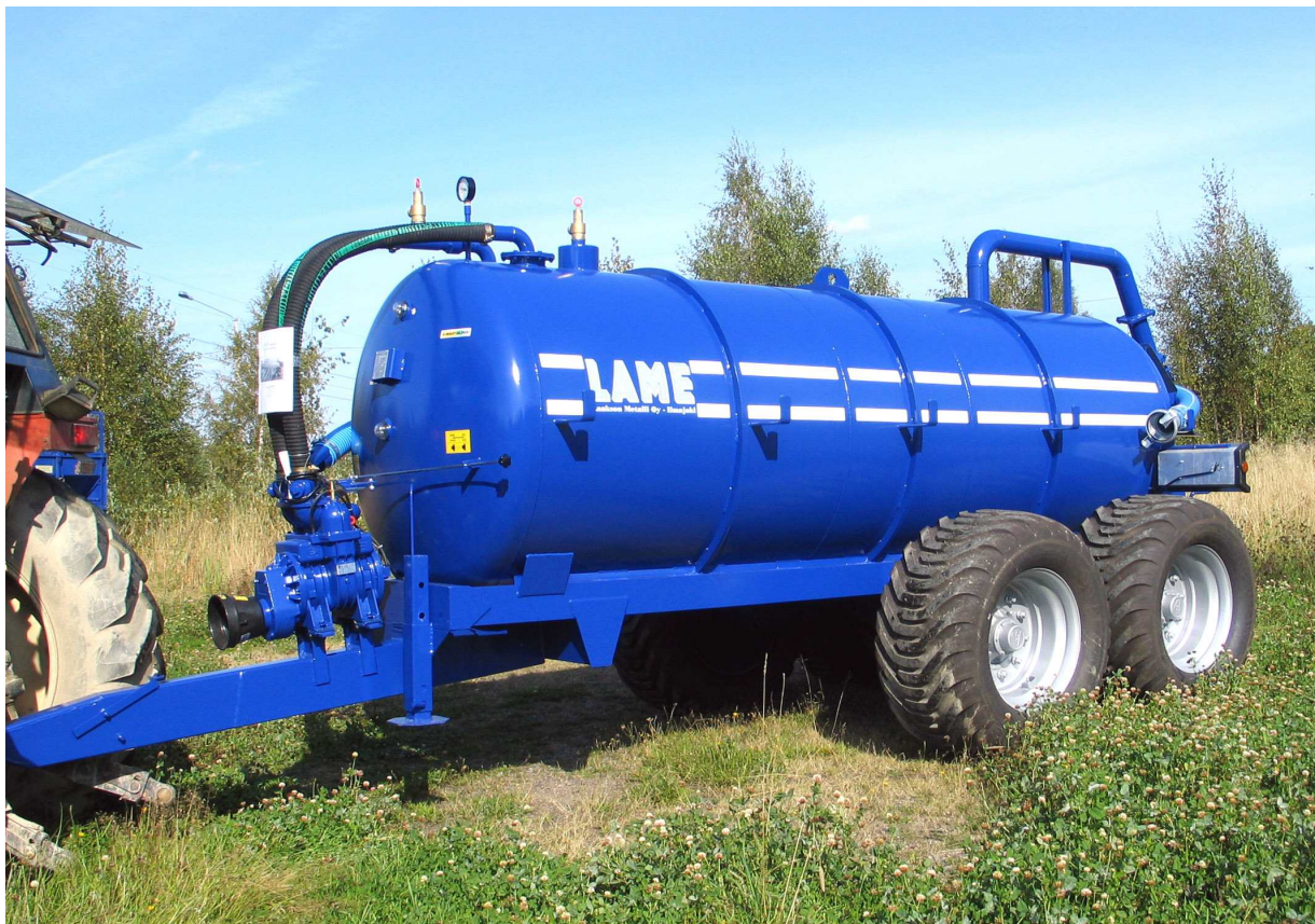
Tilavuus: 5800 litraa Yksiakselinen 550/45 - 22.5 renkailla Tyhjiöpumppu 8000 l/min
