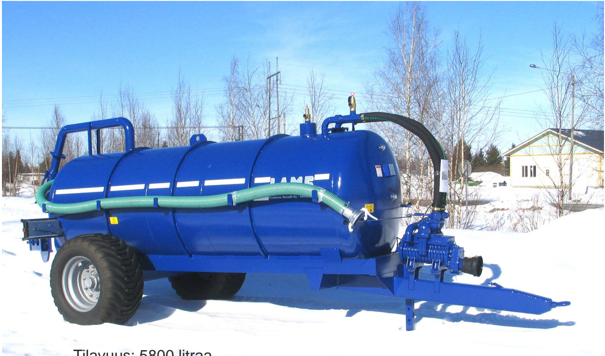
Tilavuus: 5800 litraa Yksiakselinen 550/45 - 22.5 renkailla Tyhjiöpumppu 8000 l/min
